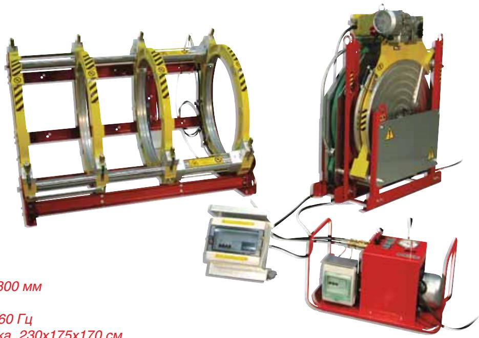
Для труб, диаметром: от 500 мм до 800 мм
