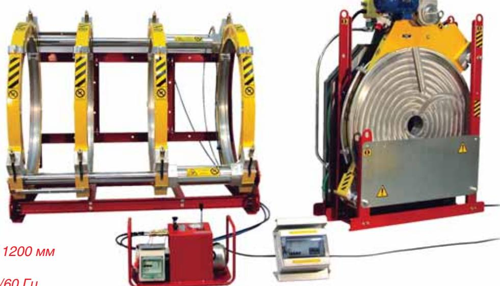
Для труб, диаметром: от 710 мм до 1200 мм
