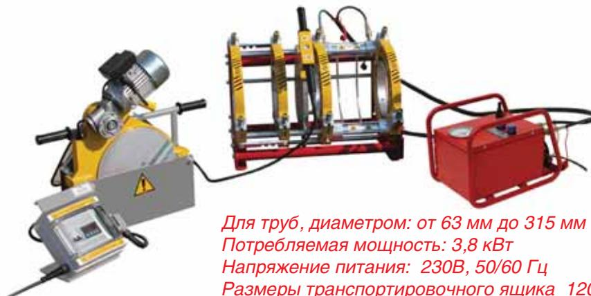
Для труб, диаметром: от 63 мм до 315 мм
