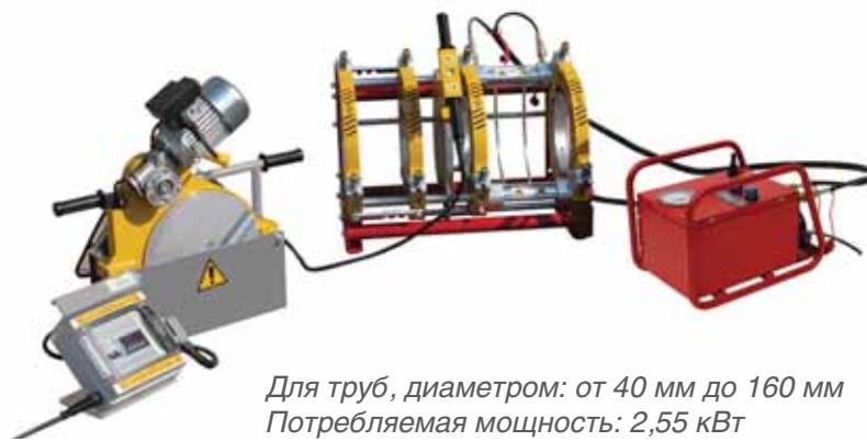
Для труб, диаметром: от 40 мм до 160 мм
