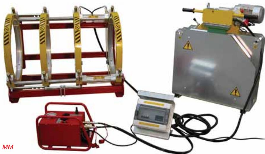
Для труб, диаметром: от 250 мм до 630 мм
