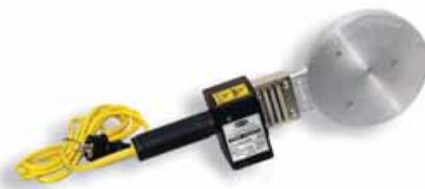
**Сварка труб диаметром:** от 16 до 110 мм
