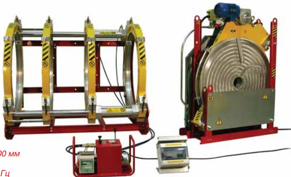
*Для труб, диаметром: от 710 мм до 1000 мм
